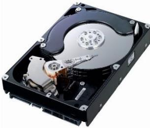
**Disco Rígido ou HD (Hard Disk)** - Fica internamente no gabinete do computador e não pode ser removido (a não ser por um técnico especializado).
